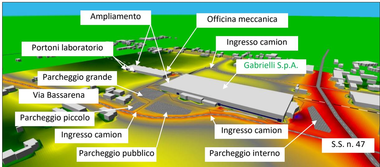
Figura 11.2. Rappresentazione 3D del modello acustico elaborato - stato di progetto
